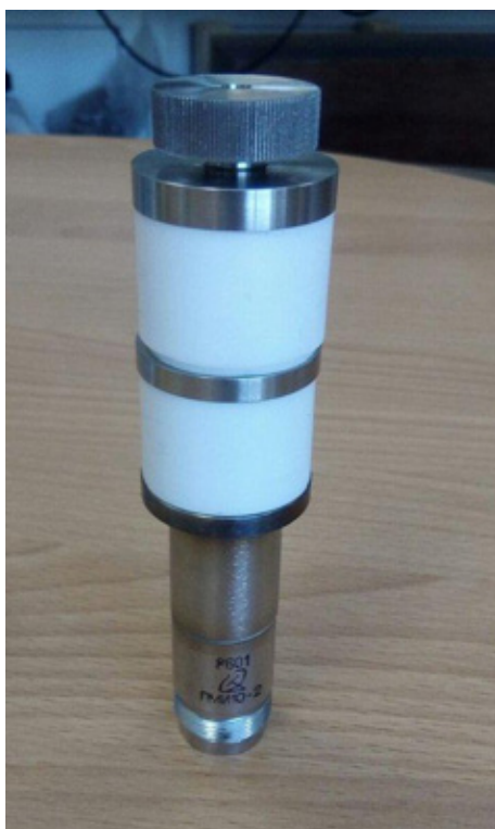
Компактный пьезоэлектрический источник ионизирующего излучения
