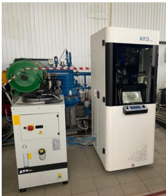
Система атомизации металлического порошка ATO LAB. Установка для производства металлических порошков с использованием технологии ультразвукового распыления металлических заготовок. Позволяет производить металлические порошки с узким распределением частиц по размерам
