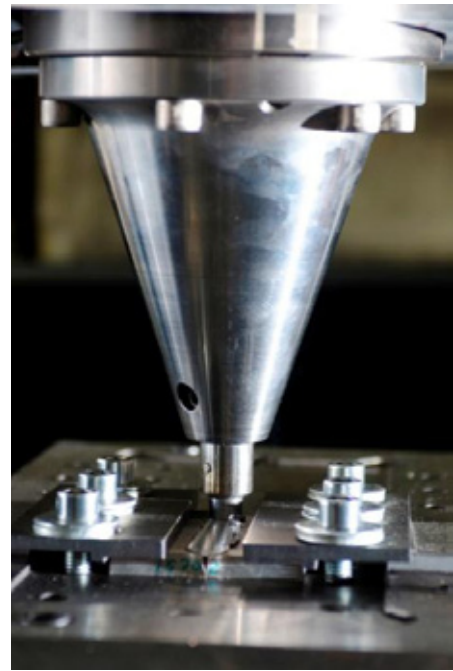
Лабораторная установка сварки трением с перемешиванием позволяет сваривать алюминиевые листы размером 400×75 мм толщиной от 1 до 10 мм. Конструкция установки позволяет применять различные сварочные инструменты для изменения характеристик получаемого шва
