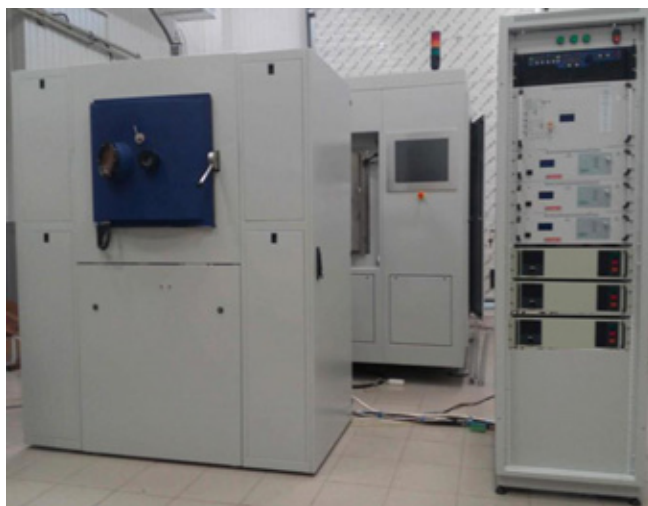
Общий вид специализированного вакуумного оборудования для нанесения покрытий на режущие инструменты, применяемые в авиационной промышленности
