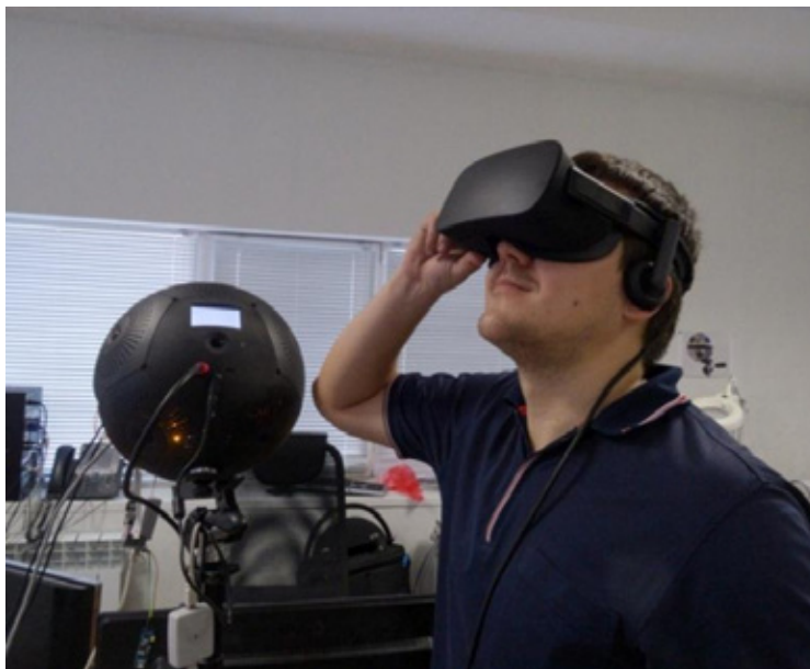
Изучение сферического видеозображения, формируемого в режиме реального времени экспериментальным образцом портативной камеры для панорамной съемки
