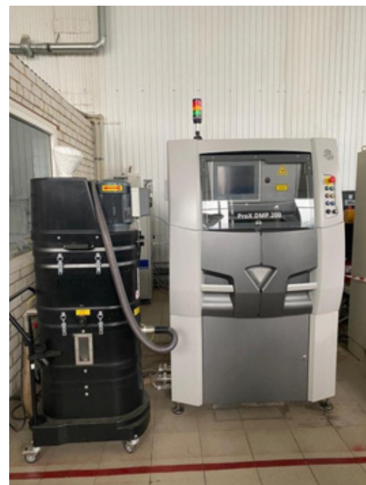
Система селективного лазерного плавления 3D Systems ProX 200. Обеспечивает изготовление из металлических порошков сложных по форме и структуре изделий высокой точности и плотности, превосходящих по физико-механическим свойствам продукты стандартных технологий
