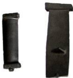
Лопатка компрессора газотурбинного двигателя из титанового сплава ВТ6 с нанокристаллической структурой
