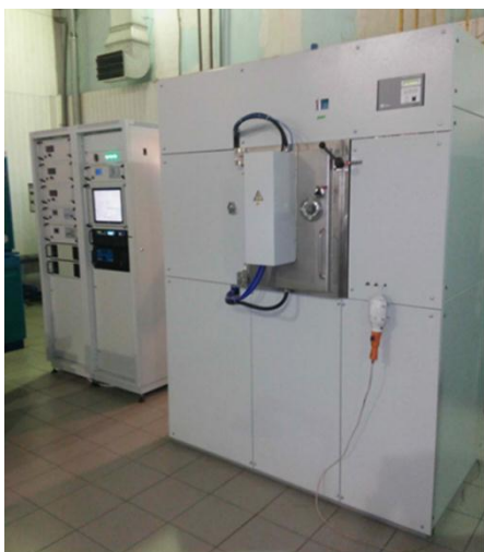
Вакуумная установка для нанесения сверхтвердого покрытия на основе аморфного углерода
