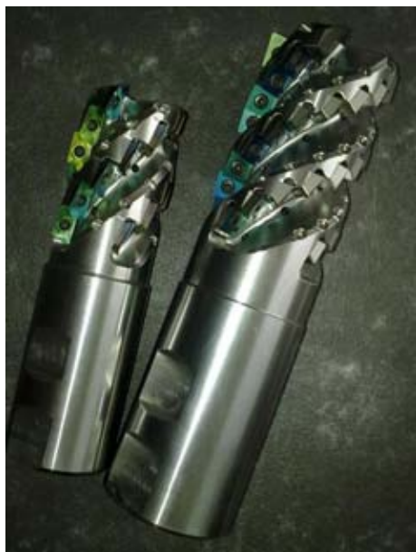
Фрезы со сменными пластинами с наноструктурным углеродным алмазоподобным покрытием
