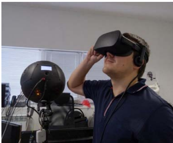
Изучение сферического видеоизображения, формируемого в режиме реального времени экспериментальным образцом портативной камеры для панорамной съемки
