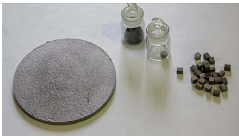
Термоэлектрические материалы на основе теллурида висмута, легированного индием, полученные с помощью искрового плазменного спекания
