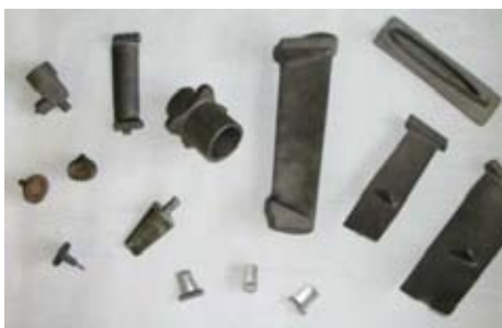
Примеры изделий из титановых сплавов, полученных изотермической (высокоскоростной сверхпластической) штамповкой: диски компрессора, «блиск», стаканы, гильзы, корпуса, лопатки и др.
