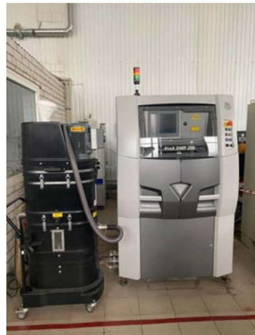
Система селективного лазерного плавления 3D Systems ProX 200. Обеспечивает изготовление из металлических порошков сложных по форме и структуре изделий высокой точности и плотности, превосходящих по физико-механическим свойствам продукты стандартных технологий
