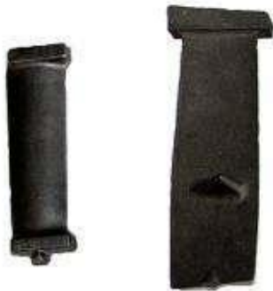
Лопатка компрессора газотурбинного двигателя из титанового сплава VT6 с нанокристаллической структурой
