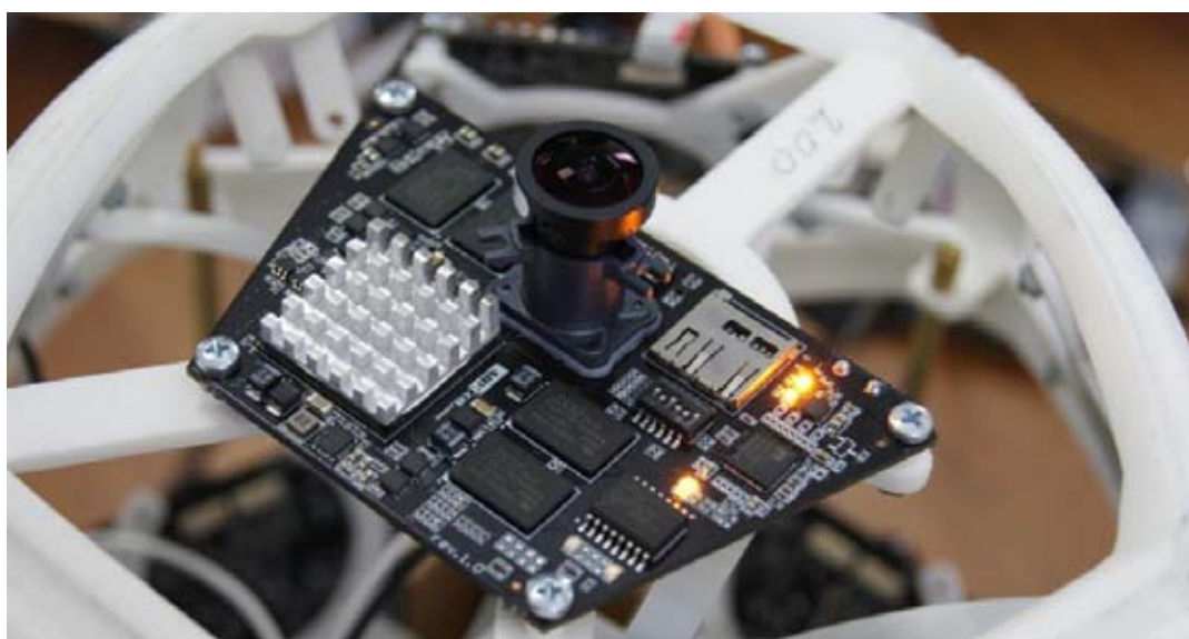
Встраиваемый интеллектуальный оптический модуль для цифровой обработки видеоданных в реальном времени (ApuCon FX5-FPGA)
