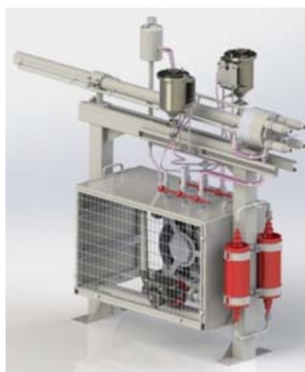
Детонационная установка Импульс-М3 (в стационарном исполнении)
